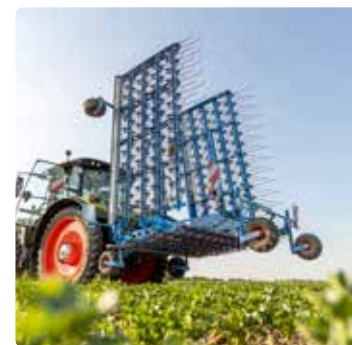
Складані зубці дозволяють безпечно транспортувати дорогами загального користування
