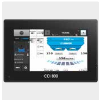
Термінал CCI 800 ISOBUS для системи керування секціями ECONOV
