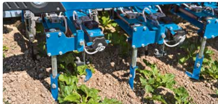
Камери в захисному корпусі й серпоподібні просапні ножі з пневматичним приводом для кожного ряду
