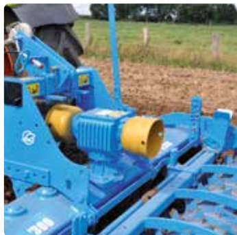
Надійний редуктор зі змінними шестірнями
