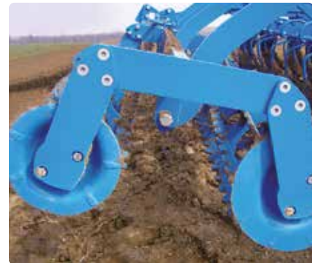
Подвійний зубчато-планчатий коток
