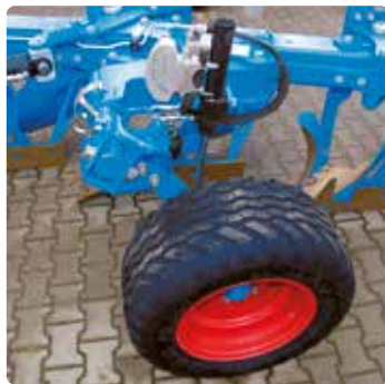
Гідравлічне регулювання робочої глибини
