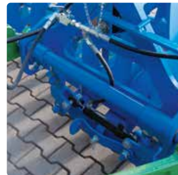
Гідравлічне натягування системи підрулювання
