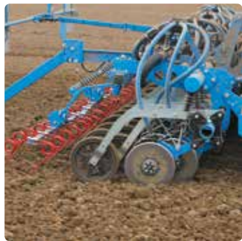
Дводисковий сошник OptiDisc: гідравлічне регулювання притиску — до 70 кг
