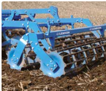
Подвійний трубчasto-планчатий коток DRF 400
