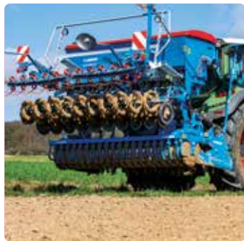
Зміщення центра ваги за допомогою гідравліки
