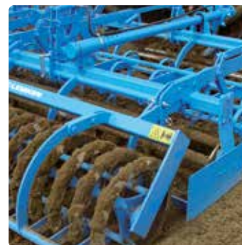
Гідравлічне регулювання вирівнювальної балки
