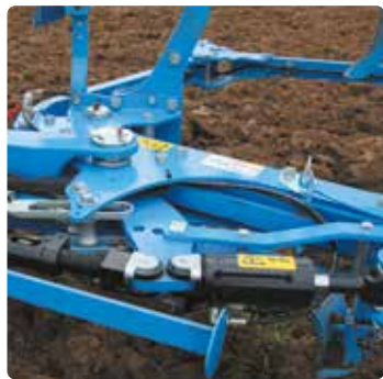
Гідравлічне регулювання робочої ширини
