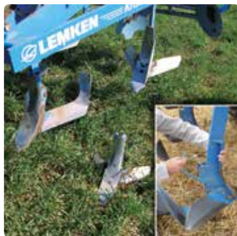
Заміна лап TriMix лапами DuoMix
