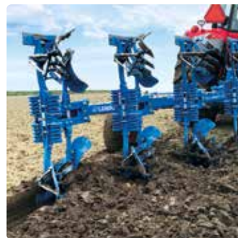
Тандемний механічний пристрій захисту від перенавантажень
