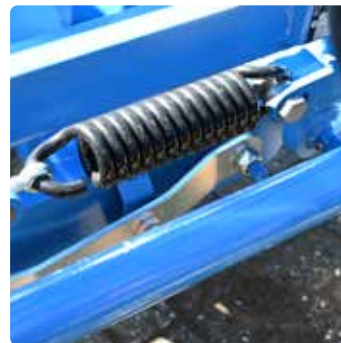
Механічне натягування системи підрулювання
