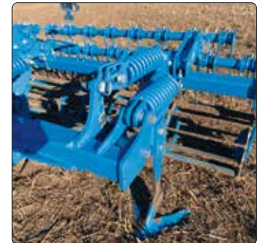
Неглибоке суцільне зрізання ґрунту
