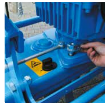
Зміна напрямку обертання для різних умов експлуатації
