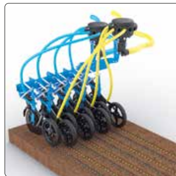
Рис. 2. Два компоненти вносяться кожен через окремий сошник
