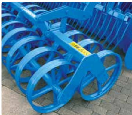
Подвійний профільний коток DPW 540
